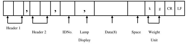
1 Header 1. : OL : Over Load, Under Load
