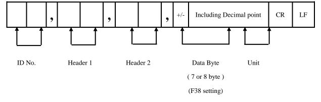
1 Header 1. : OL : Over Load, Under Load
